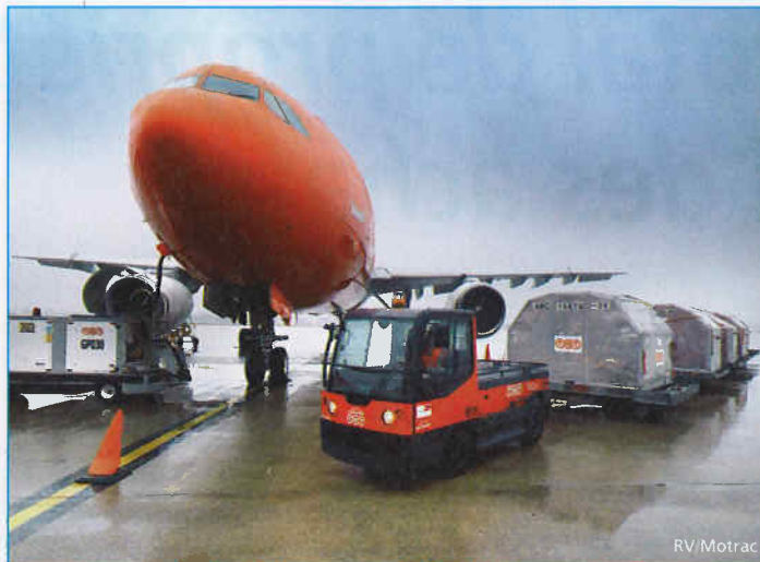
Un chargeur de cargo, modèle Linde P250 avec remorque pour tracter les conteneurs ULD.
