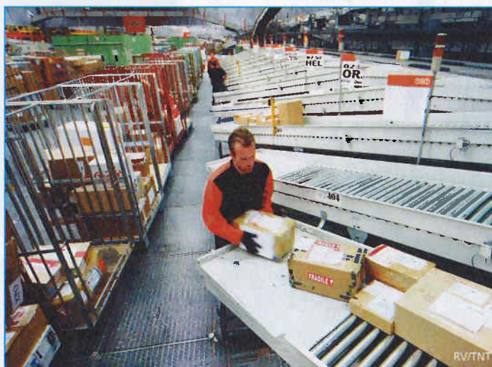
Le système de tri automatique de TNT Express à Bierset traite 30000 colis/heure et a une longueur totale de 7 km.
